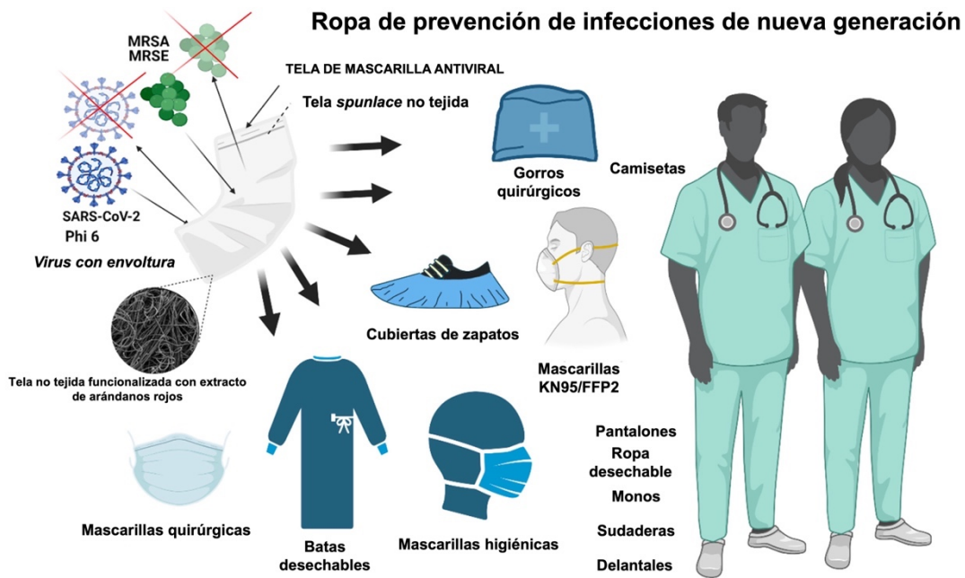
Figura 28. Representación esquemática de la utilidad de la tecnología antiviral desarrollada basada en extracto de arándanos rojos. Adaptado con permiso bajo licencia Creative Commons CC BY 4.0 de ref. [182] Copyright 2021 MDPI.
