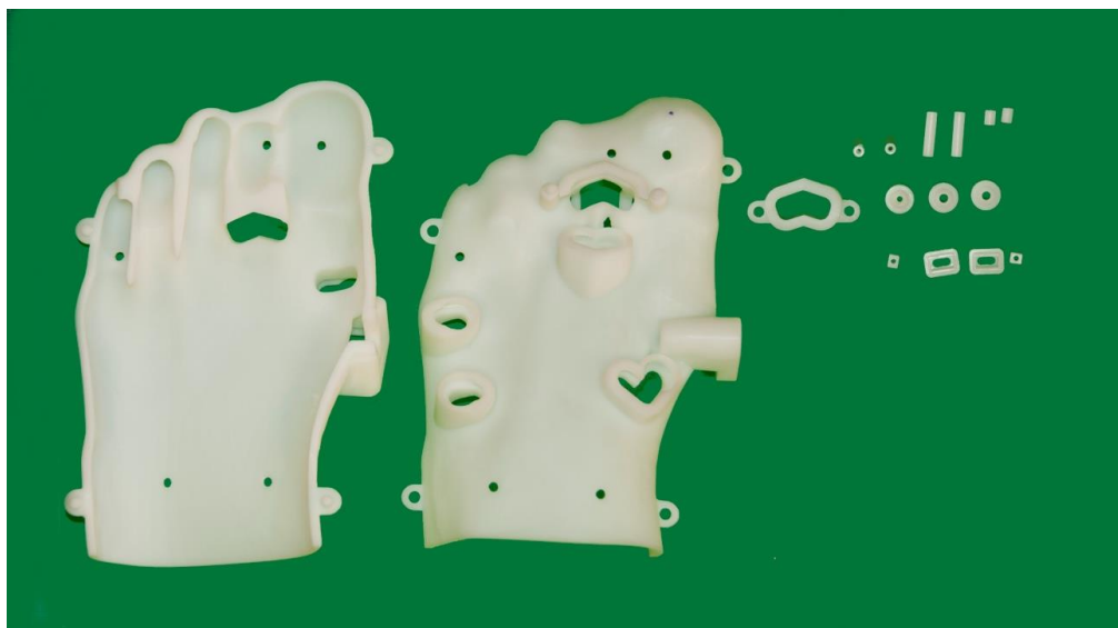
Ilustración 31: Guante quirúrgico impreso en resina Osetana, con sus respectivas guías y topes de profundidad de corte.
