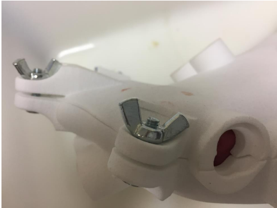
Ilustración 43: anclajes de las dos porciones del guante con palometas.
