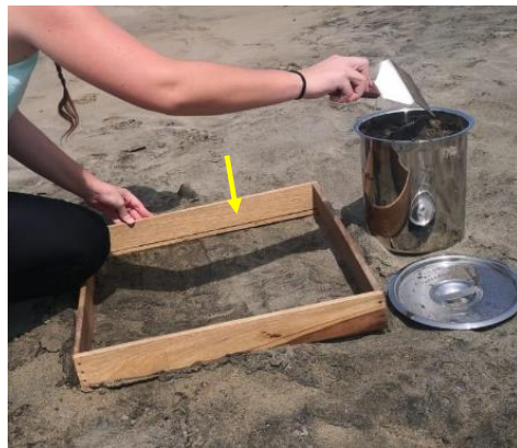
Figura 7: Recolecta de sedimentos. Se observa la cuadrícula de 1x1 con la línea de 1 cm marcada, el cubo y la pala de metal. Elaboración propia.
