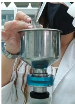
Figura13: Segunda fase de filtración. Elaboración propia
