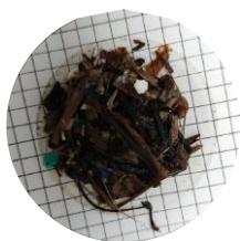
Figura 14: Filtro de nitrocelulosa después de la filtración en dos fases. Se observan plásticos a simple vista. Elaboración propia.
