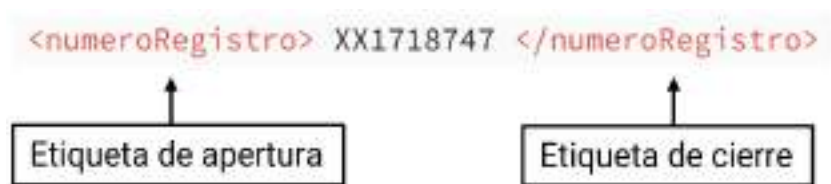
Figura 49. Elemento XML formado por una etiqueta de apertura y otra de cierre
